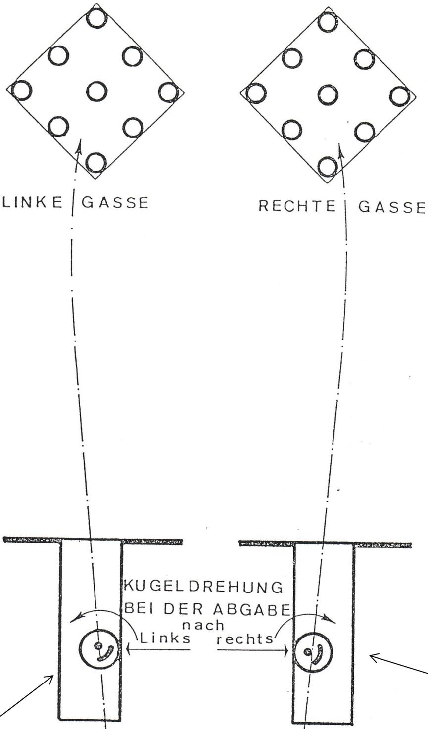
Wird die Kugel nach links gedreht, macht sie einen Rechtsbogen
